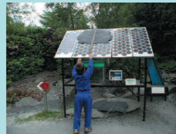
太陽光発電パネルの展示。雲形の板で押さえると装置が止まるようになっている。
