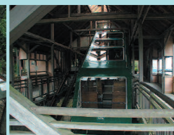
入場口にある水力（自然湧水）で動くケーブルカー。
