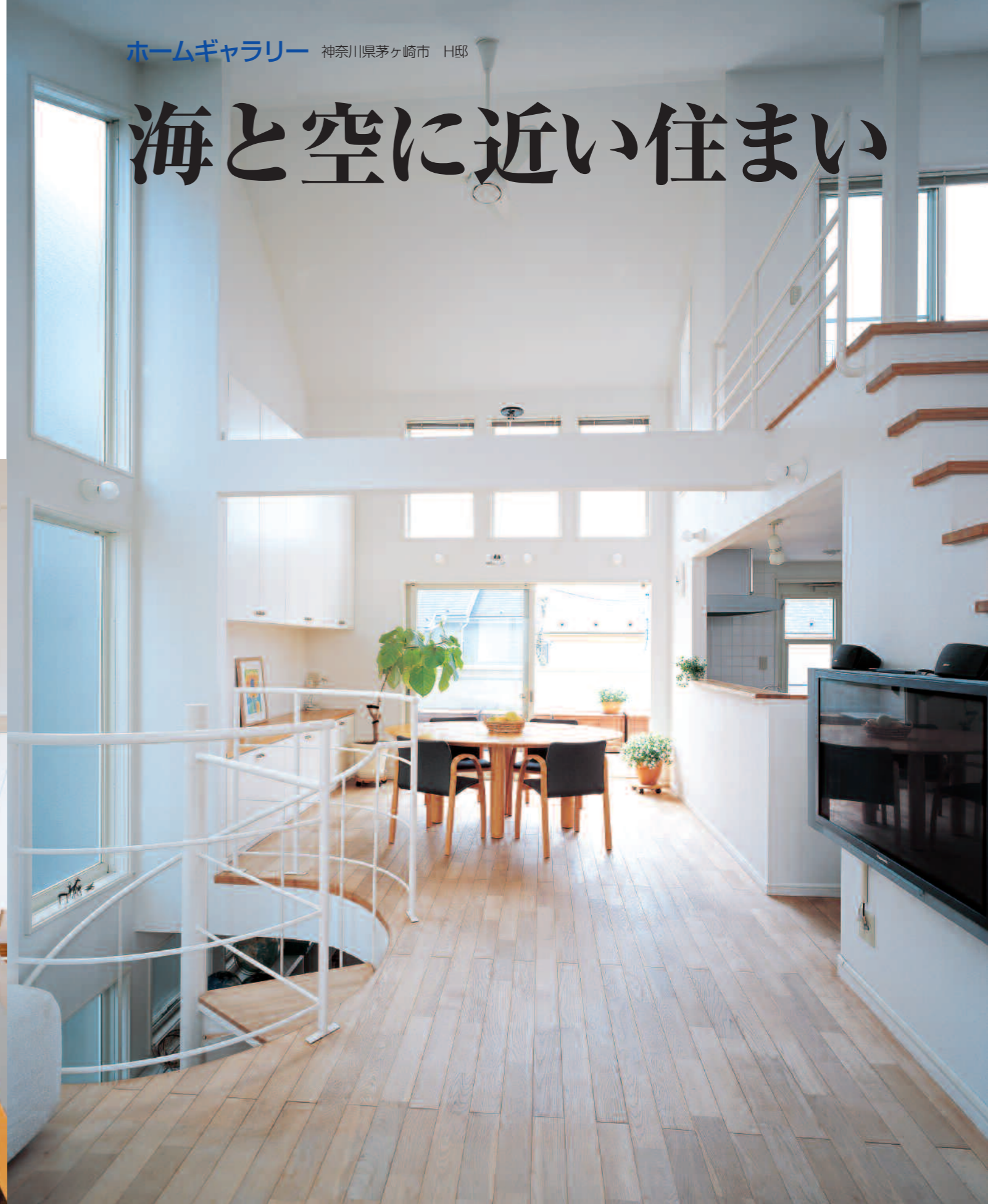
小屋裏空間を取り込んだ設計により、最大天井高5.5mという抜群の開放感が実現した2階のLDK。湘南ならではの明るい陽ざしが、白い内装に広がる。風合いのある床は、ナラ材の無垢フローリング。
